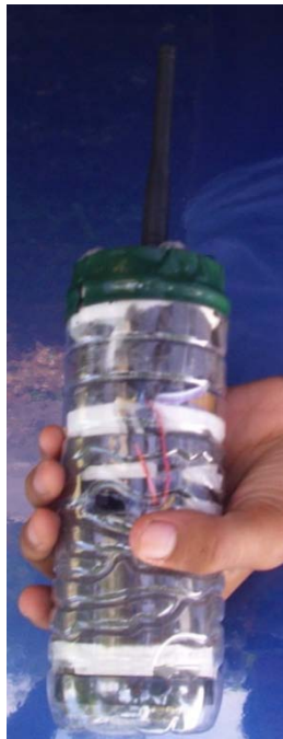
Gambar 3.1. Payload roket berisi sistem telemetri
