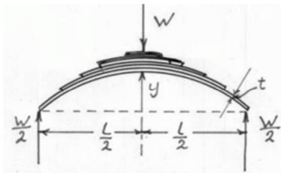
Fig. 3. Stress diagram semi-elliptic leaf spring<sup>7)</sup>
