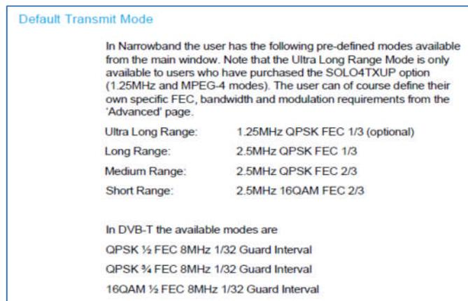
Fig. 1.Dafault Transmit Mode<sup>1)</sup>
