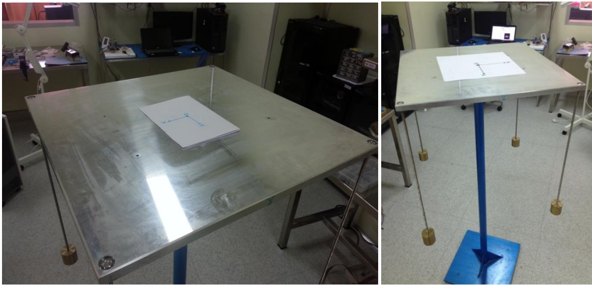
Gambar 1-2 Kerangka Pitch, Roll, dan Yaw pada Air-Bearing
